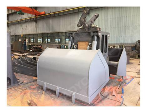
单索双瓣抓斗是一种直接挂在单卷筒起重机吊钩下,能在各种恶劣环境下装卸矿石、镍矿、煤炭、焦炭、黄沙、粮食、化肥、氧化铝、硫磺等小颗粒散货的有效工具。根据控制抓斗开闭的方式,单索双瓣抓斗又分为落地打开式双瓣抓斗、手拉式双瓣、无线遥控抓斗等;单索落地打开抓斗工作可靠,故障低,缺点是效率低。单索双瓣抓斗工作原理:抓斗的开闭通过起重机的钢丝绳的上下来控制抓斗内部滑移座沿着导轨上下滑动,吊具的导轨上设有锁扣并与下承梁固接,滑移座上设有滑轮组和启闭机构。将开启的抓斗放在物料堆上,松下钢丝绳,滑移座下滑到下承梁上,开闭机构锁住,再提升钢丝绳,抓斗开始闭合抓货;将闭合的抓斗放在物料堆上,再松下点钢丝绳,开闭机构打开,再提升钢丝绳,滑移座顶住上承梁,继续提升钢丝绳抓斗就打开卸货。单索双瓣抓斗的支持索与开闭索转换的启闭机构为星轮式启闭机构,结构简单,操作方便,能在各种状态下准确地完成启闭动作。抓斗特点是结构简单,操作方便,效率高,故障少。与起重机连接方式:抓斗的二根钢丝绳分别与起重机上的钢丝绳连接就能使用。双瓣抓斗批发厂家,欢迎来电上海豪鹰机械设备有限公司。安徽双瓣抓斗定做
