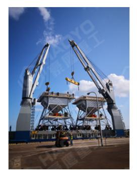
抓斗打开时,上横梁滑轮和下横梁滑轮中心距加大,然后钢丝绳落下,将已打开的抓斗,落在要抓取的散料上面,再收绕开闭钢丝绳,将上横梁滑轮与下横梁滑轮的中心距恢复到原来的位置,这样就完成了抓取物料过程。在闭合的抓斗里已装满了物料,后提升开闭钢丝绳,经轨道运行到所需卸料场地上,抓斗打开卸下所抓取的散料。抓斗起重机在散料的抓取运输上有很大的优势,是码头装卸、垃圾焚烧发电厂、林场等场所的重要运输工具。抓斗选择豪鹰。
