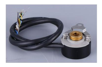
上海康比利给您介绍一下增量式编码器特点:增量式编码器转轴旋转时,有相应的脉冲输出,其旋转方向的判别和脉冲数量的增减借助后部的判向电路和计数器来实现。其计数起点任意设定,可实现多圈无限累加和测量。还可以把每转发出一个脉冲的Z信号,作为参考机械零位。编码器轴转一圈会输出固定的脉冲,脉冲数由编码器光栅的线数决定。需要提\*\*辨率时,可利用90度相位差的A□B两路信号对原脉冲数进行倍频,或者更换\*\*辨率编码器。上海康比利专业生产编码器,欢迎来电咨询。
